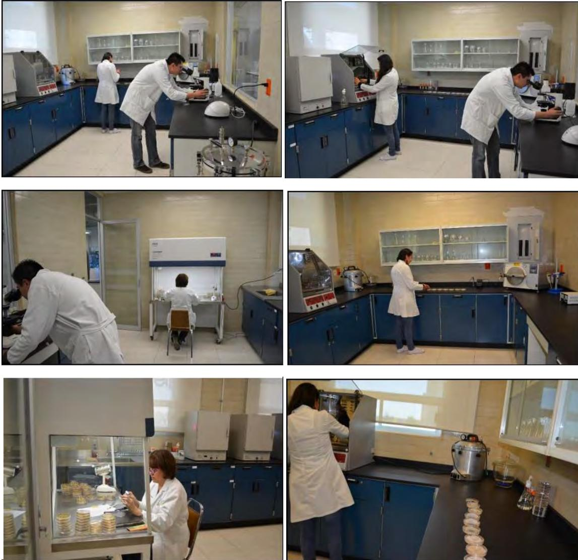
**Área de análisis generales.** Se realizan análisis de la caracterización fisicoquímica de los productos procesados tal como contenido de humedad, almidones, cenizas, minerales, proteína, carbohidratos, color, pH, acidez, entre otras propias de los productos en estudio.
